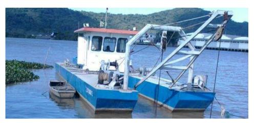
As Dragas de Sucção e Recalque com Desagregador "Cutter Suction Dredger" são ideais para desassoreamento de lagoas, rios, ETE, ETA, represas, canais e tanques de lodo; extração de areia; retirada de camada vegetal e aguapés; entre outras utilidades.
