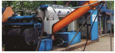
Unidades móveis de centrifugação que permitem fazer a remoção e adensamento de lodo e sedimentos, no próprio local, sem necessidade de obra estrutural.
