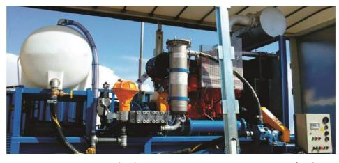
Limpeza por hidrojateamento com veículos equipados com bombas de alta pressão. Ideal para indústrias petroquímica, química, siderúrgica, alimentícia, offshore, etc.
